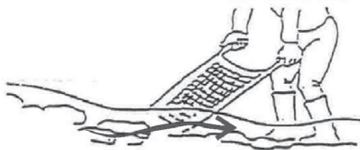
Рис. 22. Взятие проб бентоса в ручье с каменистым дном (схема)
