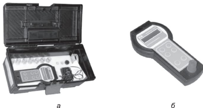
Рис. 18. Набор-укладка для фотоколориметрирования «Экотест-2020-К» а — набор-укладка в открытом виде; б — фотоколориметр «Экотест-2020».
