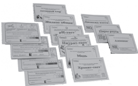
Рис. 14. Тест-системы производства ЗАО «Крисмас+» для сигнального экспресс-контроля воды и водных сред
