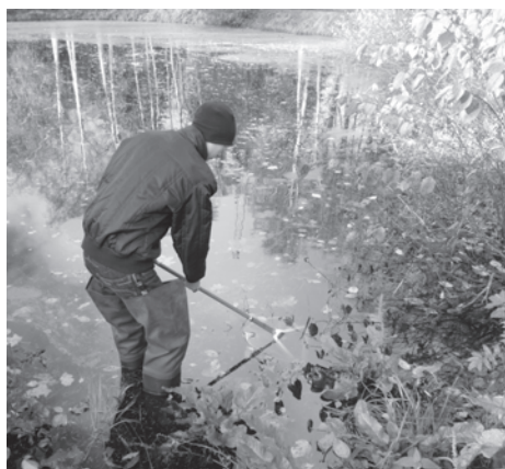
Рис. 21. Взятие пробы бентоса с использовани- ем гидробиологического сачка в сла- бопроточных и непроточных водоемах
