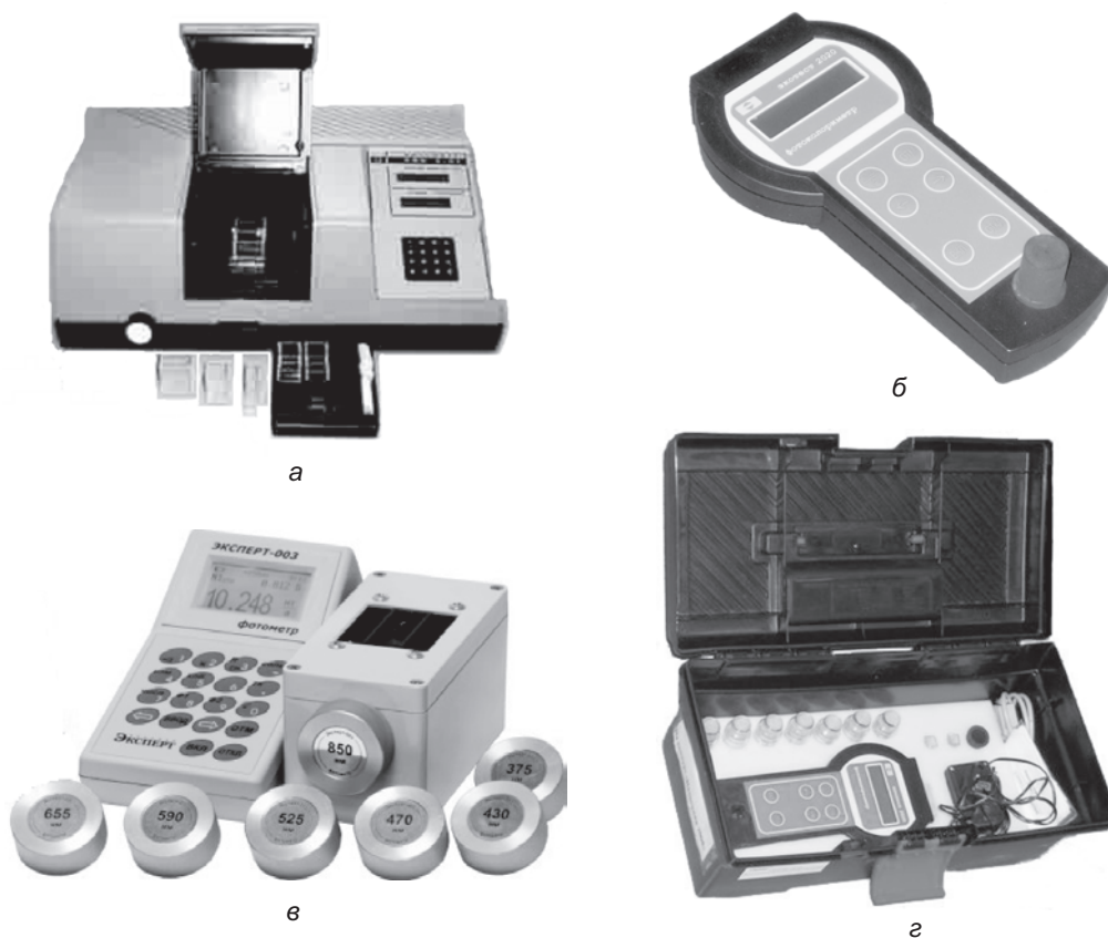
Рис. 5. Фотоэлектроколориметры: а — лабораторный фотометр марки КФК-3; б — универсальный фотоколориметр марки «Экотест-2020»; в — универсальный фотометр марки «Эксперт-003»; г — набор-укладка для полевого фотоколориметрирования «Экотест-2020-К».
